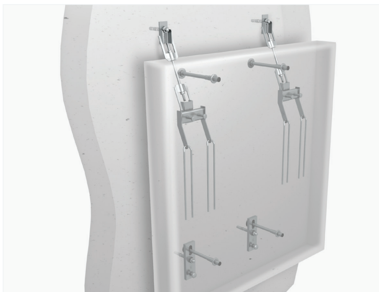
Wandabfangung mit schlank konstruierten MOSO-Hängezugankern (mit justierbarer Druckschraube) nach bauaufsichtlicher Zulassung Z-21.8-2012 Bild: 31c00735
